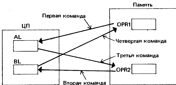
Рис. 3.8. Программный фрагмент для обмена содержимого двух ячеек памяти: а – код; б – предпринимаемые действия
